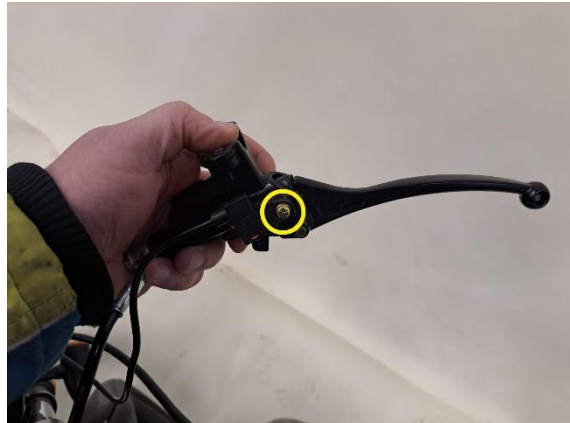
Irrota etujarruvivun mikrokytkimen kiinnitysruuvi (ristipäämeisseli ph2).
