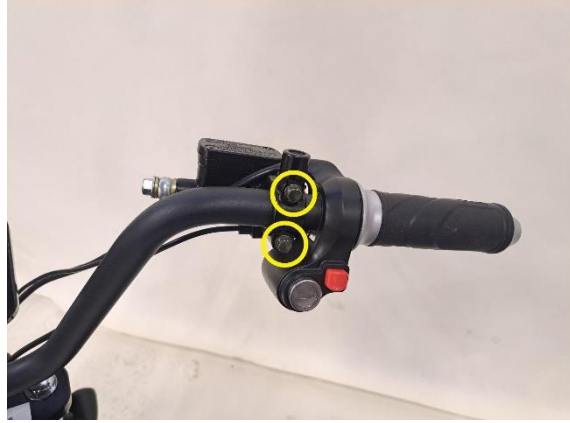
Irrota etujarruvivun runko-osan kiinnityspultit (kiintoavain 8 mm).
