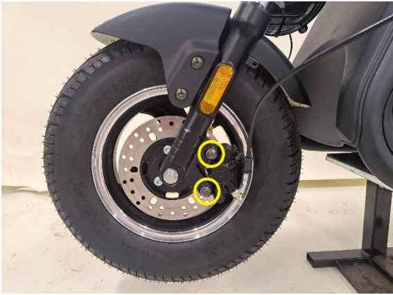
Irrota etujarrusatulan kiinnityspultit (kiintoavain 10 mm).
